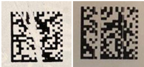
Нарушение целостности КМ*
